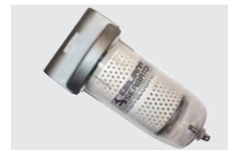
Фильтр ES-Filter для очистки от воды (10 микрон) или мех. примесей (5 микрон). ES-Filter: up to 70 l/min; Filtering capacity: 10µm water absorbing and 5µm impurities.
