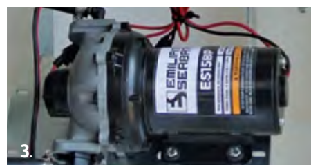
1. Насос 3,8 л / мин для мод. 30 и 110. 3.8 l/min pump fitted on mod. 30 and 110. 2. Насос 8,3 л / мин для мод. 60, 98, 220, 330 и 440. 8.3 l/min pump fitted on mod. 60, 98, 220, 330 and 440. 3. Насос 15 л / мин для мод. 980. 15 l/min pump fitted on mod. 980.
