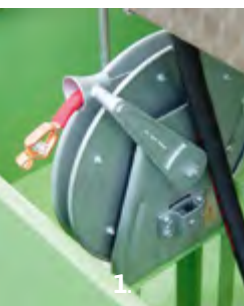
1. Система заземления. Grounding system.
