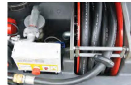
Электрический щит и катушка с пружинным приводом.
